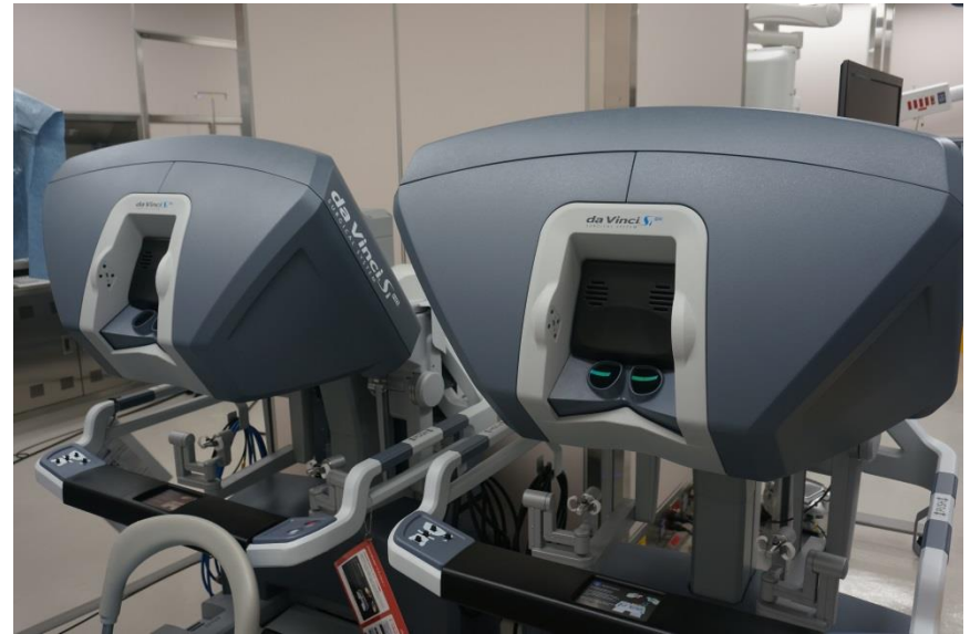
サージョンコンソール (司令塔=操作台)
